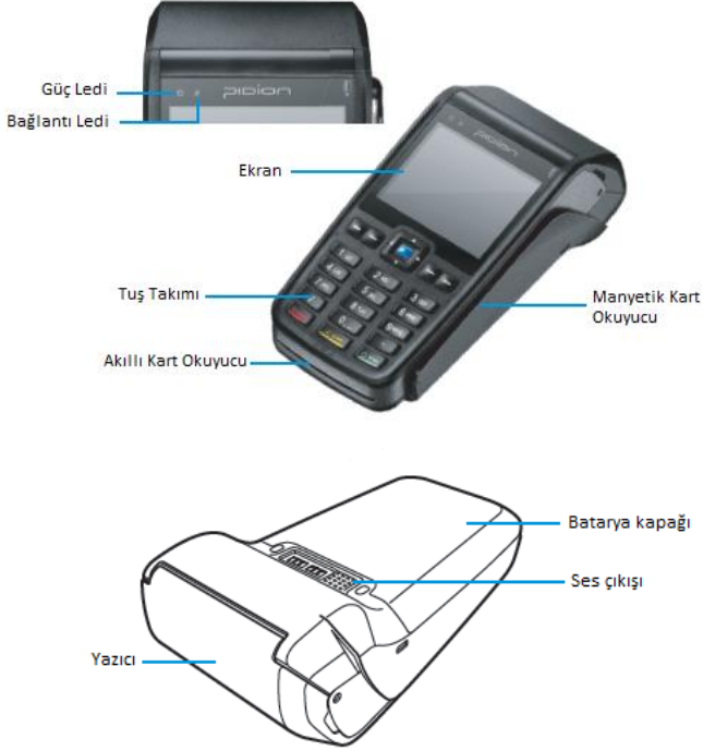
Şekil 1.1. Cihaz Bölümleri
