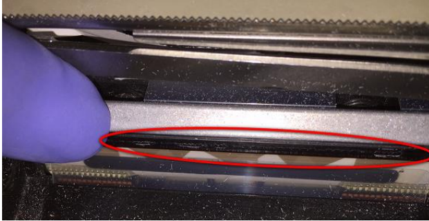
Kullanılan kâğıdın termal kafa üzerinde bıraktığı tozu tabaka
